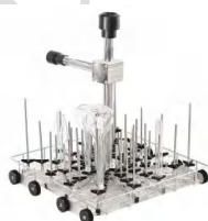
单层52位篮架 喷管52根 可改为清洗16位1L采样瓶的清洗栏架 可替换少量喷管用于清洗移液管 可替换少量喷管用于清洗5-10ml容量瓶 可替换少量喷管用于清洗小号玻璃离心管或顶空瓶
